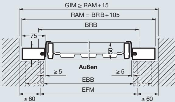
Vertikalschnitt Tor mit unterem Anschlag
