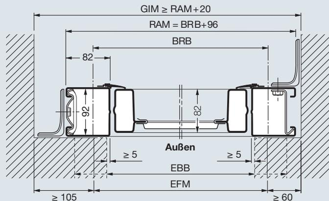
Vertikalschnitt Tor mit unterem Anschlag
